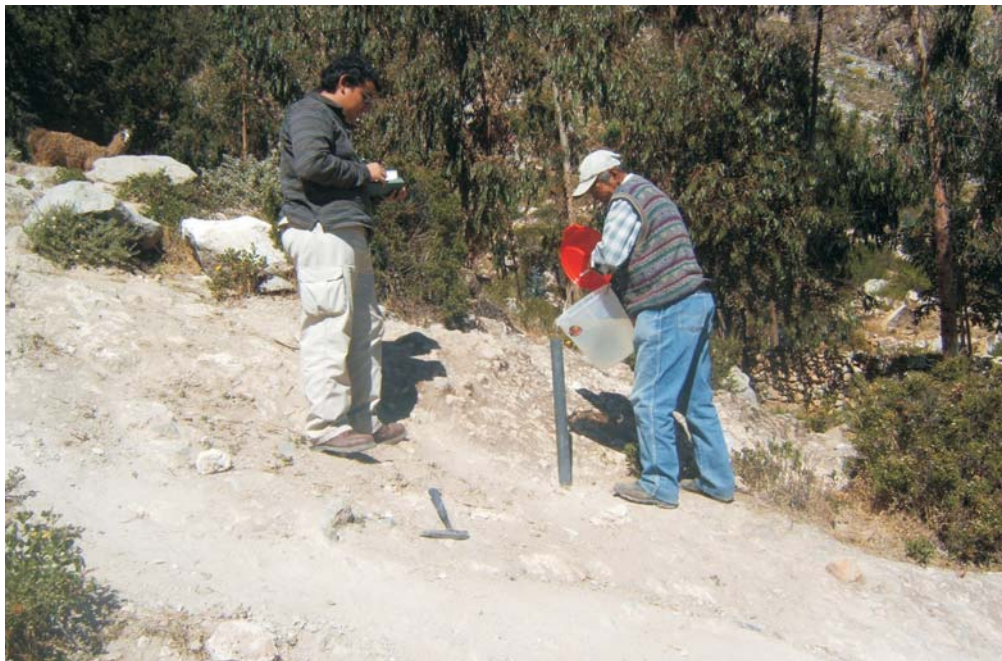
Foto 3.18 y 3.19 Pruebas de infiltración efectuadas en las fracturas de roca volcánicas (andesitas Foto 3.18 y tobas volcánicas Foto 3.19).
